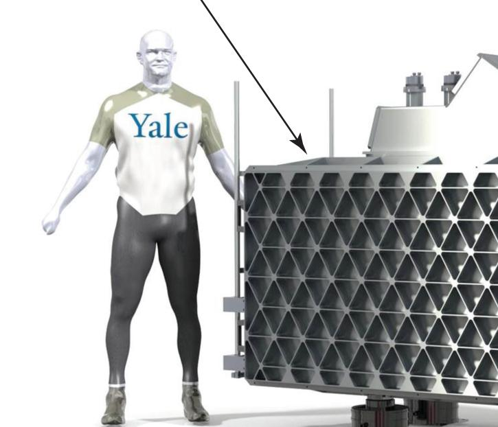
**Detector Cryostats** & Pulse Tube Coolers
